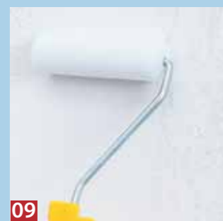
05 Später wird Bad-Weiß, eine höchst feuchtigkeitsbeständige, matte weiße Farbe, die man auch abtönen kann, aufgerollt.
