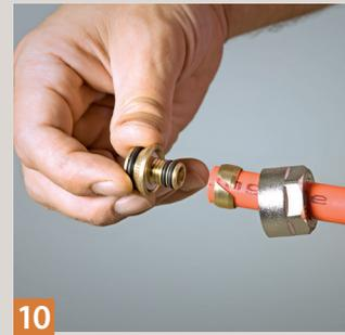
**10** Für Schraubverbindungen mit Eurokonus erst Überwurfmutter und Klemmring aufschieben, Stütz Körper ins Rohr stecken.
