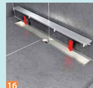
16 Die Abdeckung – als Edelstahl-Sichtabdeckung oder als Fliesenmulde – wird mit Abstandhaltern bestückt und eingebaut.
