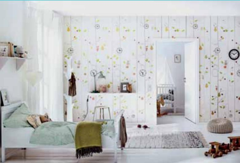
Die sogenannten Boards – wohnfertige, digital bedruckte Gipsplatten mit Glasfaserarmierung – gibt es in zwölf verschiedenen Dekoren, die durch eine Lackierung gegen äußere Einwirkungen geschützt sind.
