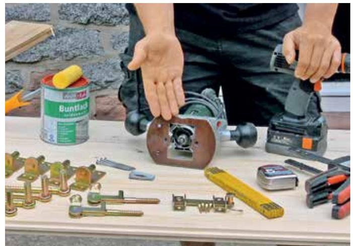
1. Benötigtes Werkzeug: Tisch- oder Handkreissäge, Oberfräse mit Schwalbenschwanzzeinsatz, Gliedermaßstab, Klemmzwingen, Akkuschrauber mit Bits, Schwingschleifer, Umschaltknarre (zur Befestigung der Schlossschrauben), Gabelschlüssel, Handhobel, Schlagbohrmaschine für die Befestigung im Mauerwerk, Winkel, Werkstisch, Bleistift.
