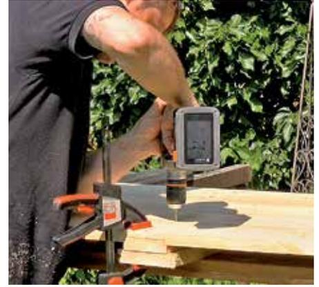
12. Mit Akkuschauber und Bohrer (analog zum Schraubendurchmesser) bohren.
