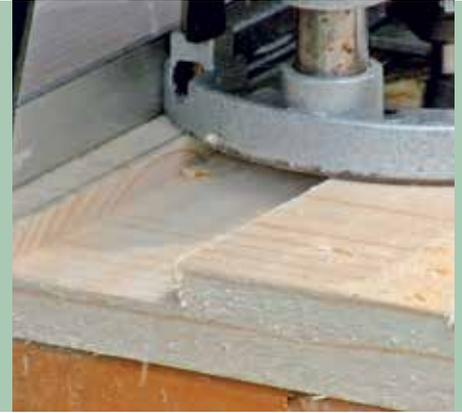
4. Führung mit der Schraubzwinde fixieren und die Frästiefe auf ein Drittel der Materialdicke einstellen. Beim Fräsen den Führungsanschlag jeweils um 1,5 cm (Durchmesser Fräskopf beachten) versetzen bis die ganze Aussparung für den Querries gefräst ist.
