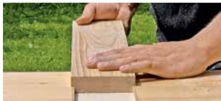
... Abstand zwischen Schwalbenschwanzfräse bis Außenkante der Oberfräse achten. Führungsanschlag 4,5 cm von der Fräskante nach außen versetzen (je Fräse unterschiedlich). 7. Die fertigen vier Querriese sollten sich stramm einschieben lassen und werden später mit Holzschrauben fixiert.
