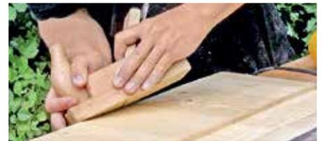
8. Mit dem Handhobel Kanten bearbeiten und mit Exzentrerschleifer bzw. Schleifklotz und Schleifpapier feinschleifen.
