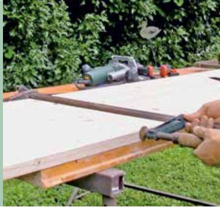
3. Nut- und Federbretter auf Breite des einzelnen Klappladens zusammenstecken, gleichmäßig ausgemittelt anzeichnen und einzelne Bretter mit der Tisch- oder Handkreissäge an der Längskante auf Laibungsmaß abschneiden. Die Bretter zusammenstecken, an der geraden Werkbankkante anlegen und gegeneinander mit zwei Schraubzwingen fixieren.
