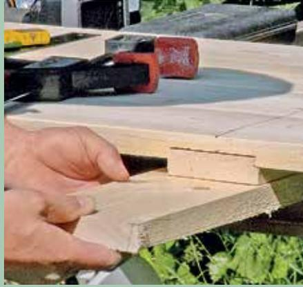
11. Vor dem Bohren auf der Unterseite des Klappladens ein Stück Restholz festspannen, damit das Holz beim Bohren nicht ausreißt.
