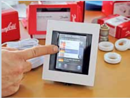
13. Nächster Arbeitsschritt für den Heizungsinstallateur: Konfiguration des mit Farbtouchscreen ausgestatteten zentralen Bedienteils.
