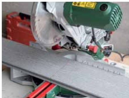
2. Der Laserstrahl signalisiert, ob die Diele für den 90-Grad-Schnitt auch korrekt anliegt.
