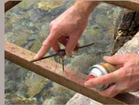
9. Nun in Etappen und mit Kühlöl das Gewinde schneiden. Immer wieder den Span brechen.
