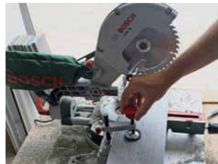
3. Hilfreich auch die Feststelleinrichtung, mit der das Werkstück zusätzlich fixiert werden kann.
