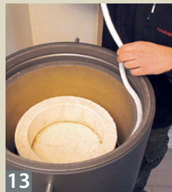
08 Abstandshalter sorgen dafür, dass die nach oben steigenden heißen Rauchgase optimal durch die Zugringe zirkulieren.
