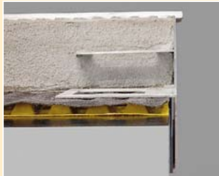
4. Winkelprofile in L-Form (unten) haben einen quadratisch gelochten Schenkel, der vollständig in Dünnbettmörtel eingebettet wird.
