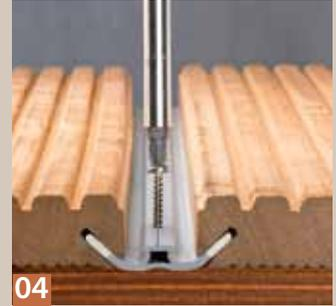
**04** ... das Profil vorgebohrt. Dann wird es mit mit 4-mm-Flachkopfschrauben an der Unterkonstruktion festgeschraubt.
