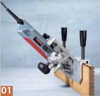
**01** Wer keine vorgefertigten Dielen einsetzen will, kann mit Hilfe einer Fräsvorrichtung auch eigenes Material mit Fugen ausstatten.
