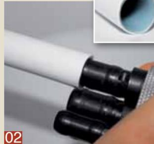
**02** Mit dem passenden Kalibrierdorn nun das Innenrohr runden und leicht anschrägen. Den Kalibrierer bis zum Anschlag drehen.
