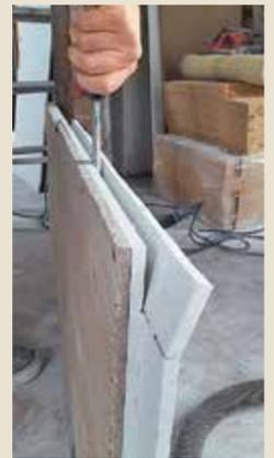
**D** ... obere Platte, die ja nur punktuell mit der zweiten verklebt ist, mit einem flachen Werkzeug (z. B. einem Stechbeitel) abhebeln.
