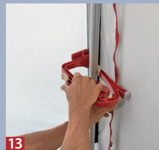
09 ... arretiert die gewünschte Länge über das rote Verbindungsstück. Die maximale Länge liegt dann bei zirka 250 Zentimeter.
