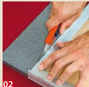
02 Aus den 15 mm dicken Seitenrandplatten (Liefermaß 300 x 360 mm) schneidet man sich die Formteile maßgenau zurecht.
