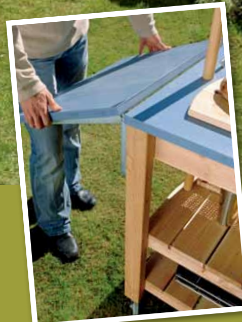
5. Die Längs- und Seitenteile werden verbunden: Kleber auftragen, etwas abbinden lassen ...
