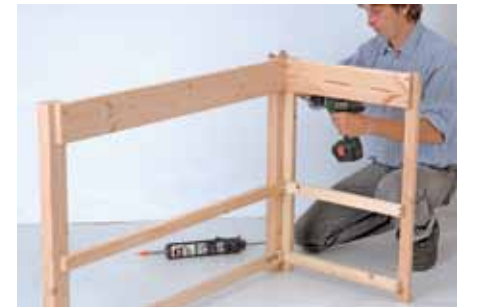
6. ... und die Schrauben so eindrehen, dass die Köpfe ganz in den Senkungen verschwinden.
