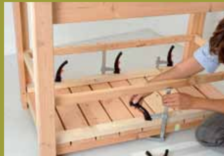
7. Die verklebten Regalbodenbretter werden mit zwei Hilfslatten und Hebelzwingen fixiert.
