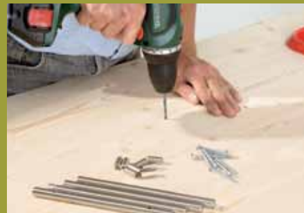
11. Durch acht Bohrungen werden die Abstell-Möbelgriffe von unten her angeschraubt.
