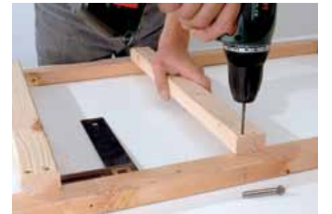
2. Alle Schraublöcher werden vorgebohrt und erhalten eine Senkung für die Schraubenköpfe.
