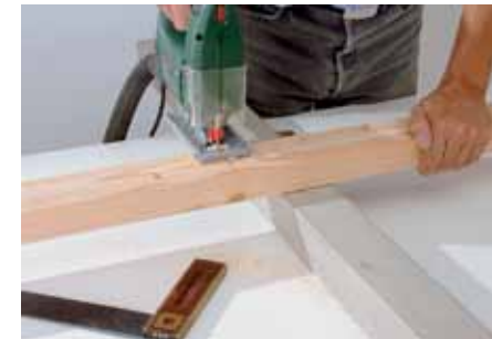
1. Alle Hölzer werden nach Plan vermaßt, zugeschnitten und an den Kanten leicht gebrochen.
