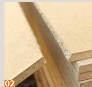
02 ... Trapezklingenmesser tief eingeritzt und anschließend über eine Kante gebrochen. Da die neue Kante im Stoßbereich ...
