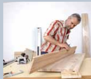
14. Dann hat man die Setzstufen gewendet und die Stellbretter entlang der Markierungslinie angelegt.
