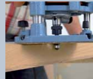
22. Die Leistenkanten wurden mit der Oberfräse leicht angefast, um deren Schärfe abzumildern.
