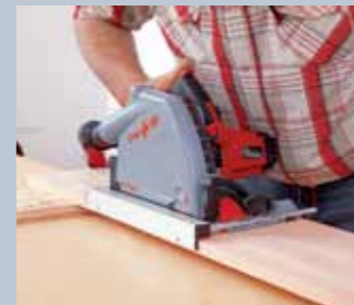
21. Auch die restlichen Stufenkantenleisten hat man sich aus 18er-Platten zurechtgeschnitten.
