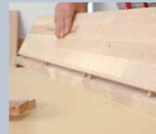
19. Für das obere Stellbrett hat man die randnahe mögliche Runddübelverbindung vorgezogen.
