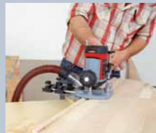
13. Denn an den Unterseiten der Stufenüberstände werden Nuten für die Stellbretter eingefräst.
