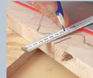
7. Auf dem Holz wird dann die Eintauchposition der hinteren Sägeblattkante angezeichnet.
