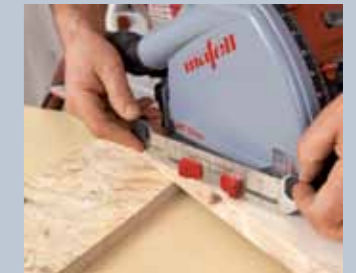
6. Zum Teil musste man mit dem Sägeblatt ins Holz eintauchen – da war die Einstellhilfe praktisch.
