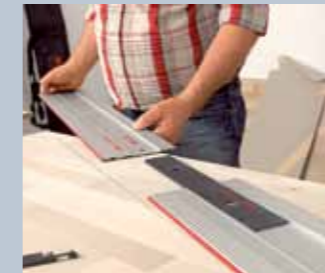
4. Dann waren viele Zuschnitte erforderlich. Eine verlängerbare Schiene für die Handkreissäge ...
