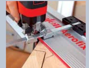
9. ... dann allerdings leichter mit der Stichsäge zu erstellen. Auch die wird an der Schiene geführt.
