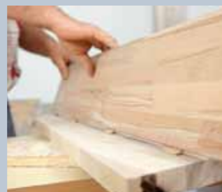
17. ... erfolgte mit sogenannten Flachdübeln. Der hintere Überstand verschwindet im Unterbau.
