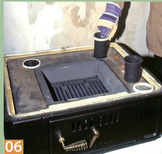
**06** Für das Wärmetauscher-Modell benötigt man Hülsen, die in die Bohrungen gesteckt werden. Dichtringe nicht vergessen!
