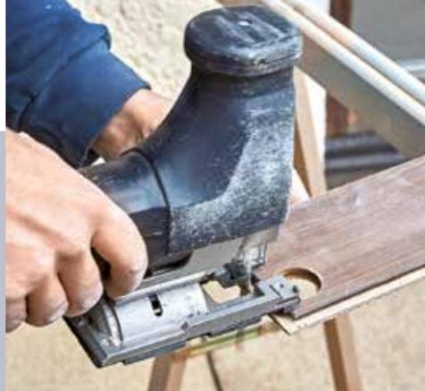
**6** Die passende Rundung wurde zuerst mit der Lochsäge erstellt, dann sägte man mit der Stichsäge von außen her bis an die Lochkontur und erzeugte so ein Langloch.
