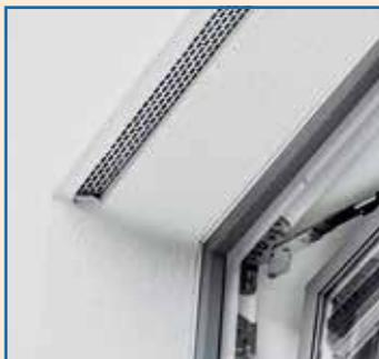
Zur Fenstersturzausbildung der Knauf Vorhangfassade gehört u. a. die erforderliche Lüftungsöffnung zur Gewährleistung der funktionsfähigen Hinterlüftung der Fassade. Die Lüftungsöffnung ist hier optional mit einem Kleintiergitterschutz mit definierter Lochung versehen.
