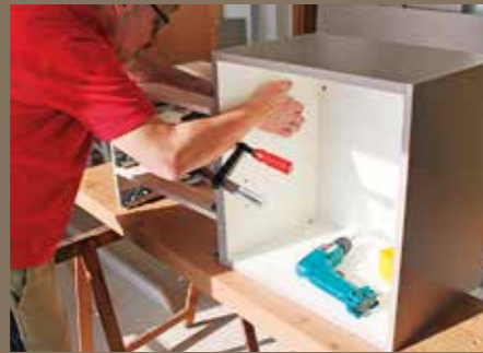
13. Aus zwei Oberschrankkorpusen und einer Zwischenverbindung aus 4 Einschubelementen wird die später frei hängende Anrichte gefertigt.
