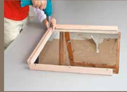
9. Für das später eingesenkte Spülbecken verschraubt man an der nur 16 mm dicken Platte von unten her Versteifungsleisten aus Holz.
