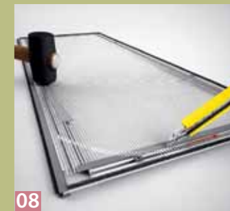
04 Mit Hilfe der Eckverbinder kann der Rahmen nun zusammengesteckt werden, wenn nötig unter Einsatz eines Gummihammers.
