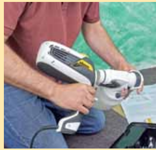
6. Dann den Behälter an der Pistole fest anschrauben. Damit ist das Gerät schon bereit fürs Arbeiten.
