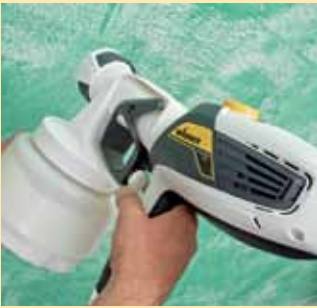
7. Am Stellrad wird noch der Zugweg am Pistolengriff reguliert. Dies beeinflusst dann die Farbmenge.
