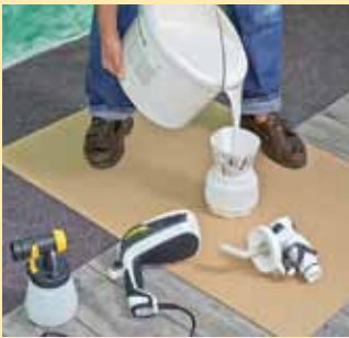
5. Weiße Farbe in den Farbbehälter der Sprühpistole füllen. Eimer hochhalten, damit der Strahl dünn wird.
