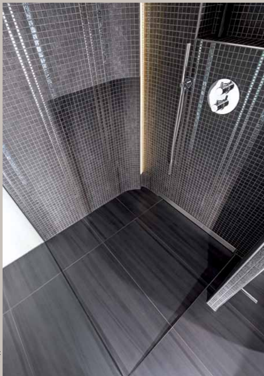
25. Stolze 1400 x 1200 Millimeter bietet die Dusch-Ecklösung. Vorgefertigte Aussparungen im Bodenelement und in den Wandplatten nehmen die Glasscheiben auf.
